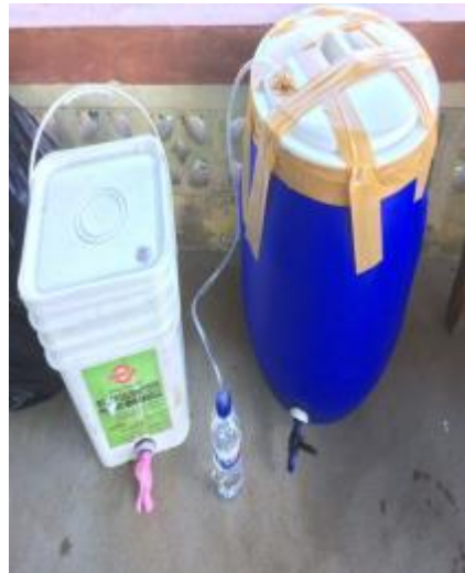
Gambar 6 : Limbah olahan ikan yang telah dicampur dengan bahan lainnya, lalu ditutup rapat selama 3 minggu
