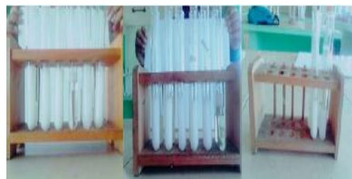
Gambar 2. Hasil Uji Turbinitas formula nanoemulsi teknik SNEDDS
